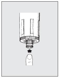
En pressant le bouton on obtient la purge des condensats même quand le circuit est sous pression.
