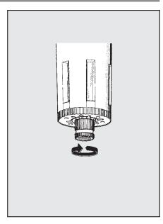
En tournant le bouton dans le sens horaire le système de purge est fermé en présence ou en absence de pression.
