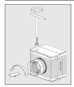
La série 400 comporte un système breveté de brides avec raccords tournants et coulissants permettant d'adapter l'ensemble FRL à la cote d'entraxe résultant de la coupe des tubes.
