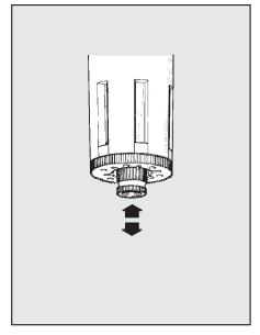
Le système de purge semi automatique est du type normalement ouvert. En absence de pression dans la cuve, le système de purge est ouvert et les condensats peuvent s'évacuer vers l'extérieur par gravité. Avec le bouton en position centrale la purge est en position semi automatique. Quand il y a de la pression dans le circuit le système de purge est fermé.
