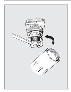
Avant démontage de la cuve, s'assurer que l'appareil n'est pas sous pression. Effectuer le démontage comme indiqué sur le schéma ci-contre.
